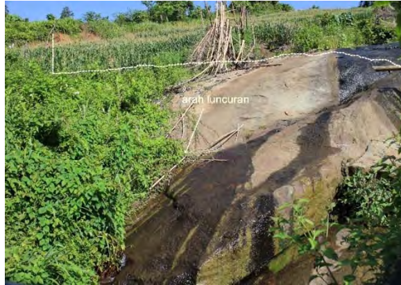
Gambar 10. Pergerakan massa pada dua litologi tufa dan breksi vulkanik) yang berbeda menghasilkan bidang luncuran berbentuk cembung.
